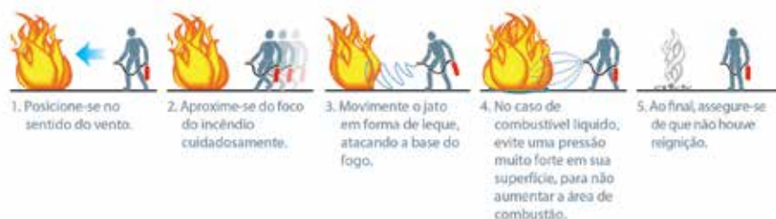
Figura 17 – Utilização de Extintores Portáteis
