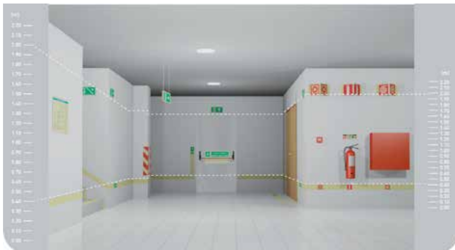
Figura 6 – Sinalização de Emergência
