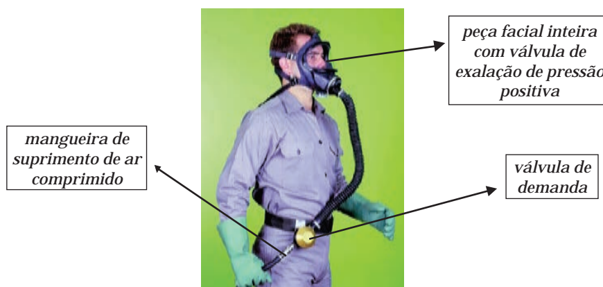
Figura 19: EPR de adução de ar tipo linha de ar comprimido de demanda com pressão positiva e com peça facial inteira
