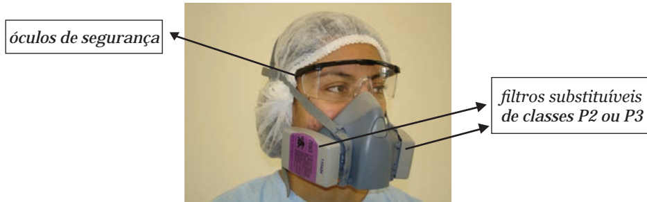
Figura 11: EPR purificador de ar com peça semifacial e filtros substituíveis de classes P2 ou P3 aos pares
