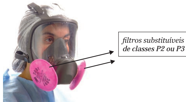
Figura 12: EPR purificador de ar com peça facial inteira e filtros substituíveis de classes P2 ou P3 aos pares
